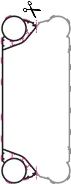
Abb.1: Schneiden Sie die rot schraffierten Dichtungsteile ab
