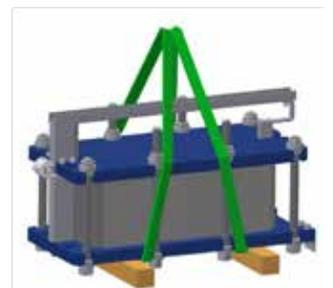
Heben Sie den Plattenwärmetauscher auf die Holzbohlen
